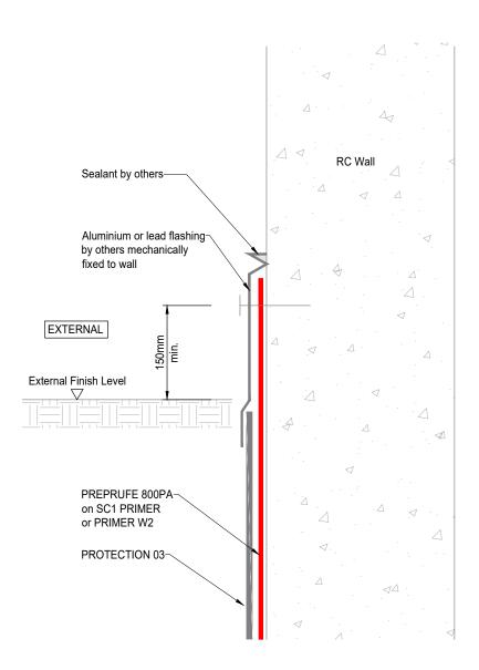
GROUND LEVEL TERMINATION ON RC WALL
