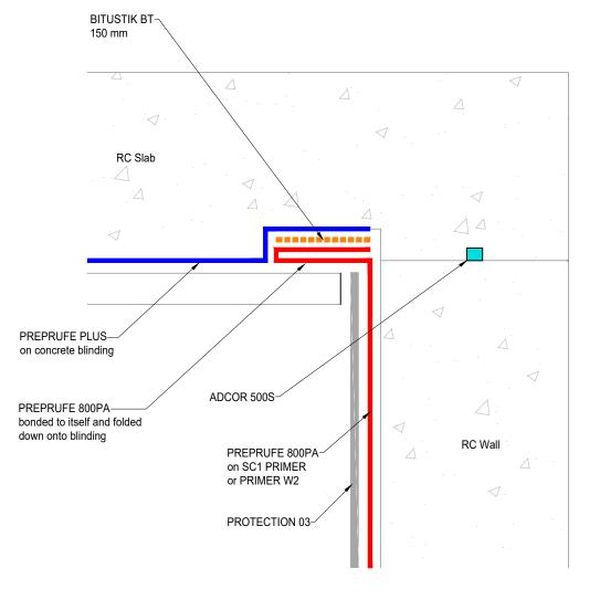
**B** WALL-UPPER SLAB CONSTRUCTION JOINT Section
